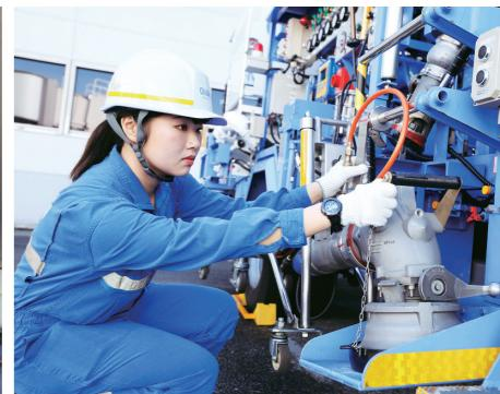
※ハイドロントシステム:大型タンカーで運ばれてきた航空燃料を空港沖の桟橋で受け入れ、タンクで貯蔵。地下配管を通じて飛行機まで圧送されるシステム。
