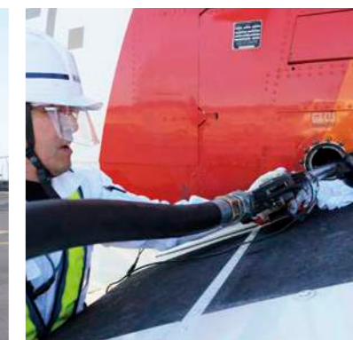
目視による油面確認
